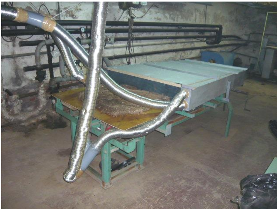
Рис. 6. Экспериментальный стенд для изучения процесса сушки в камере щелевого типа
